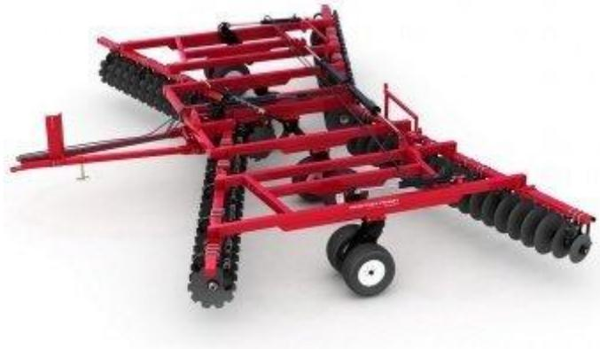
Тандемные тяжелые дисковые бороны (X-образные или двухследные) созданы для окультуривания залежных земель (целины), обработки паров, подготовки поля к пару или посеву, заделки пожнивных остатков, а также удобрений в почву. Все тандемные бороны комплектуются плавающим дышлом, что позволяет производить более ровную обработку поля в
