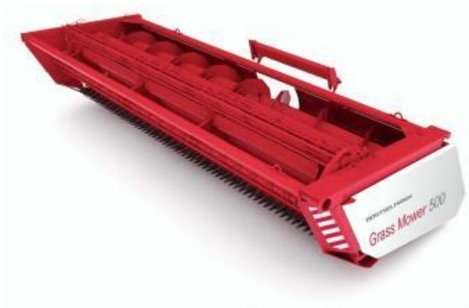
Косилка-плющилка GM-500 с сегментно-пальцевым режущим аппаратом в составе с универсальной самоходной косилкой KSU-1 предназначена для скашивания с плющением или без плющения и укладки в валок сеяных и естественных трав. Косилка оснащена универсальным режущим аппаратом с креплением сегментов на болтах, для удобства сервисного обслуживания и повышенной поступательной скоростью движения ножа.
