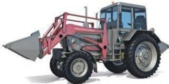
Надежный и прочный погрузчик фронтальный универсальный Fenix 800 предназначен для погрузки таких грузов, как снег, щебень, песок, сено, солома, силос, навоз, минеральные удобрения, и т.д., а также для перевозки и укладки в скирды рулонов и копен сена, соломы. Погрузчик Fenix 800 многофункционален и универсален, круг его возможностей широк, благодаря набору сменных
