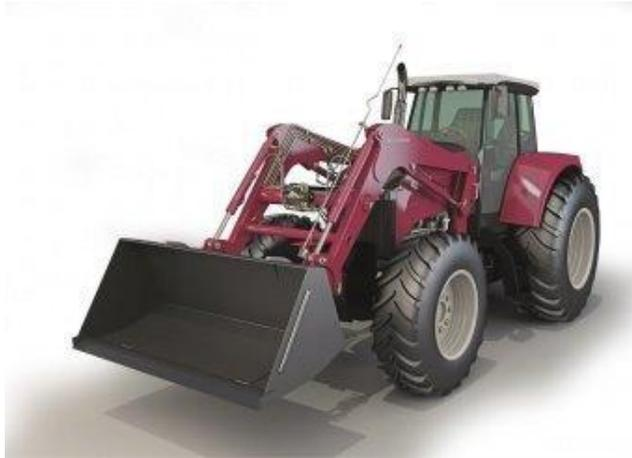
Погрузчик фронтальный навесной ПФН-3000 к трактору Row Crop поможет выполнить такие работы, как погрузка различных сельскохозяйственных грузов (навоза, минеральных удобрений, песка и т.п.) в транспортные средства, смесительные установки и машины для внесения удобрений, механизация внутрискладских работ с затаренными и незатаренными минеральными удобрениями и другими грузами, погрузка и укладка рулонов.
