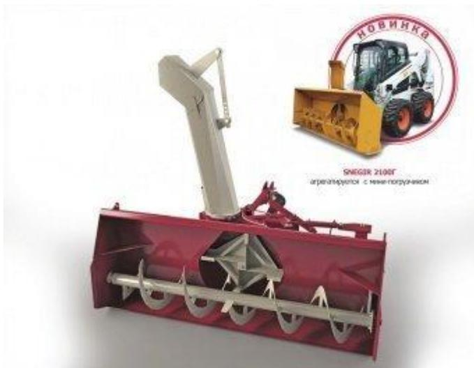
Машина снегоуборочная шнекороторная СШР "Snegir" идеально очистит от свежесвыпавшего и слежавшегося снега дороги и шоссе, городские магистрали, взлетно-посадочные полосы аэродромов, удалит снежные насыпи, созданные плужными снегоочистителями, а так же пробьет дороги по снежной целине.
