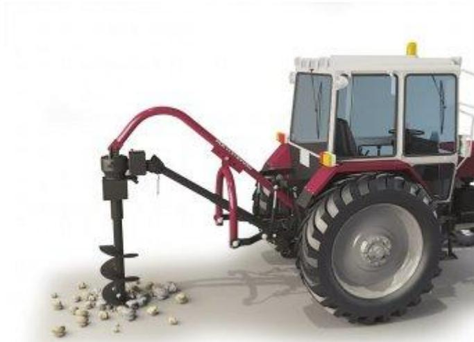
Бур шнековый БШ-6/9 создан для бурения ям. Сложные технологические операции он осуществляет без усилий. Подготовка к бурению происходит быстро и не требует сложных действий – достаточно закрепления бура с помощью трехточечной навески и подключения гидравлики.
