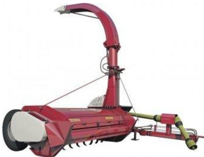
Многофункциональный **прицепной кормоуборочный комбайн STERN 2000** обладает широкими возможностями: скашивает и подбирает валок с последующим измельчением и загружает массу в транспортное средство или прицепной накопитель. Производительность комбайна достигает 38 т/час. Режущие элементы, выполненные из специальной легированной стали,
