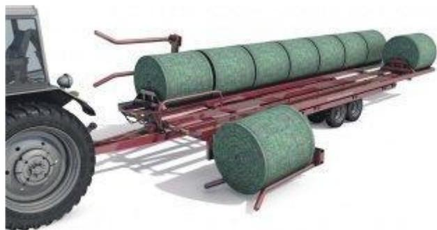
Самозагрузочные тележки для перевозки рулонов – это лучший способ бережного сбора вашего урожая. Аккуратный подбор и загрузка рулонов проводится вилочным захватом, который с помощью гидроцилиндра поднимает рулон на платформу. Далее передняя стенка передвигает рулон назад. Разгрузка производится методом сдвига рулонов передней стенкой через задний гидравлически-открывающийся борт. Они легко скользят по направляющим, сохраняя форму и целостность.
