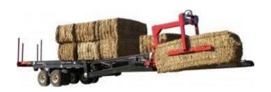
Прицеп для перевозки тюков ТПТ-20 предназначен для самостоятельной загрузки, транспортировки и разгрузки тюков крупнопакующих прессподборщиков ППТ-1270 Tukan Max. ТПТ-20 позволяет одному оператору производить загрузку и перевозку тюков без остановки, за один проход, не выходя из кабины трактора. Таким образом, можно загрузить до 20 тюков на одну т€лежку.
