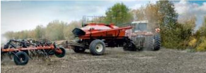
Посевные комплексы серии SH и SC используются во всех зонах возделывания, кроме зоны горного земледелия, и предназначены для посева зерновых, зернобобовых культур и внутрипочвенного внесения минеральных удобрений.
