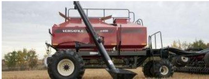
Пневматические бункеры-раздатчики Versatile поставляются в конфигурациях Tow-between («Бункер за трактором») and Tow-behind (Бункер за культиватором). Вместимость бункеров - 7575л, 9514, 11099л и 13743л. Обеспечивают равномерное распределение и доставку удобрений и семян к рабочим органам сеялки. Независимо от типа и размера семян, точность внесения - это гарантированный результат
