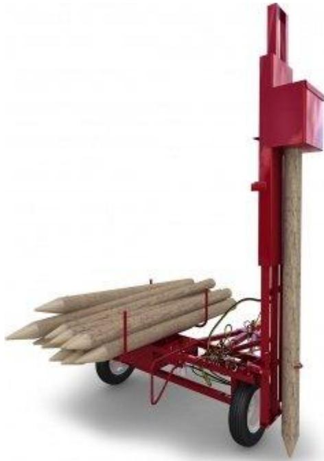
**Прицепной шпалерный столбостав СП-320** предназначен для запрессовки в почву шпалерных столбов и кольев на виноградниках, ягодниках, в шпалерных садах, на пастбищах, фермах. Доступны модификации, работающие как от ВОМ трактора, так и автономно, от установленного двигателя внутреннего сгорания. Машина идеально подходит для
