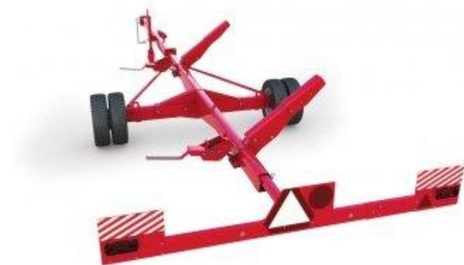
Тележка применяется для перевозки жаток и приспособлений шириной захвата от 5 до 9 м. по дорогам общего назначения и по
