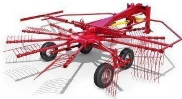
Навесные роторные грабли KOLIBRI 350/471 демонстрируют отличные результаты с минимальными потерями. С производительностью до 5 га/ч они тщательно сгребают травы из прокосов в валки, осуществляют оборачивание, разбрасывание и сдваивание валков сена. Возможность выбора ширины валка за счет регулируемого отражателя позволяет настраивать грабли под технику на следующем этапе кормозаготовки.
