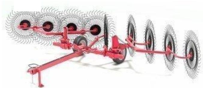
**Грабли колесно-пальцевые ГKP-600 и ГKP-900 "Kolibri V"** очень надежны и просты в эксплуатации. Они используются во всех зонах равнинного землепользования при уборке высокоурожайных сеяных и естественных сенокосов. Отличительная особенность колесно-пальцевых граблей - многофункциональность. Они могут выполнять несколько видов полевых
