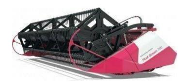
Унифицированные жатки низкого среза Float Stream обеспечивают скашивание зерновых, колосовых, крупяных, зернобобовых культур и льна на высоте от 3 до 14 см. Минимальное расстояние от поверхности поля до режущих элементов жатки позволяет особенно эффективно убирать полеглые растения, а также сою или нут с низким расположением первых
