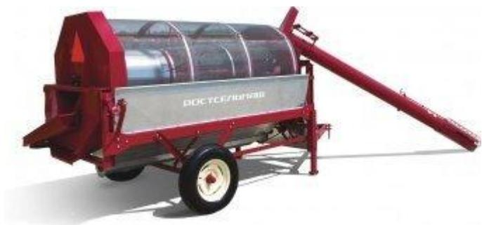
Зерноочиститель ОЗМ предназначен для предварительной двухступенчатой очистки зерна (пшеница, овес, ячмень, кукуруза, семена подсолнечника и пр.) от грубых и крупных посторонних и солоmistых примесей с целью
