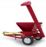
Вальцовые зерновые мельницы созданы для равномерного дробления зерновых культур (пшеница, рожь, ячмень), семян бобовых и масленичных растений. Могут использоваться как самостоятельные машины, а также в составе технологических линий для производства.
