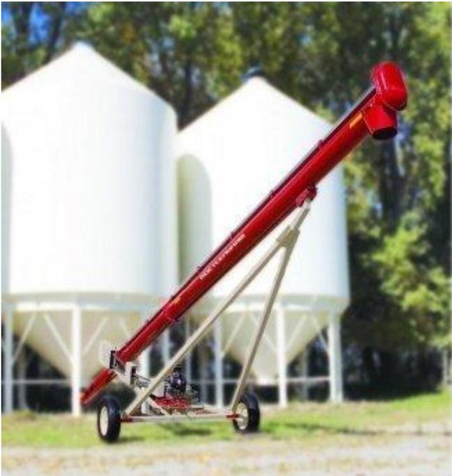
Перегрузчики зерна предназначены для загрузки зернохранилищ из транспортного средства и погрузки транспортного средства из зернохранилища зерна (пшеница, кукуруза, семена, комбикорма
