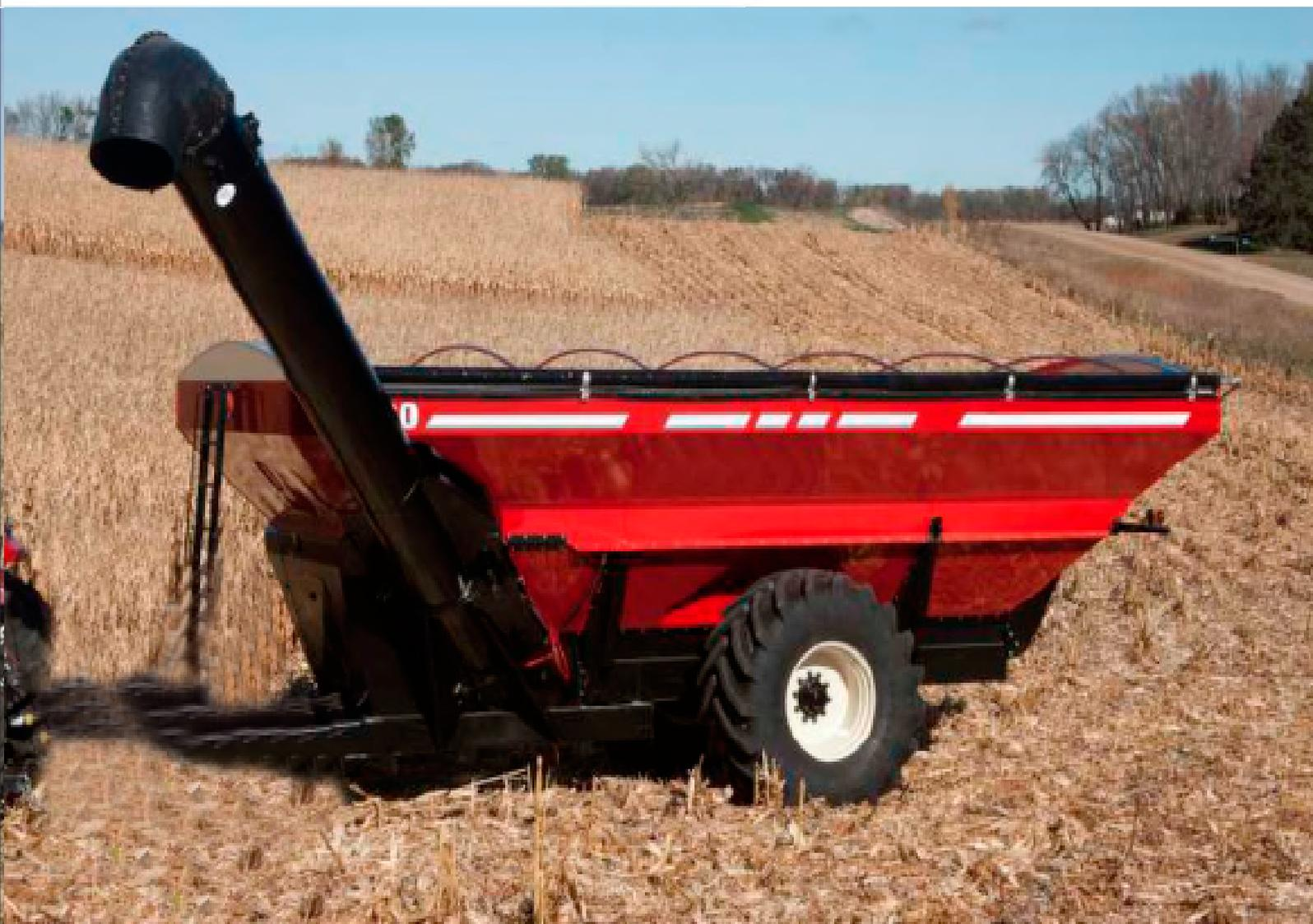
Бункер-зерновоз применяется для приема зерна во время уборки зерновых и пропашных культур с комбайна, накопления и дальнейшей перевозки к краю поля и перегрузки в автомобиль-зерновоз. При этом процесс выгрузки зерна из комбайна не требует его остановки и обеспечивает непрерывность уборочного процесса
