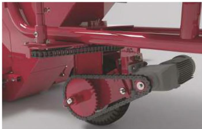
**Привода переднего хода** с импортным мотор-редуктором гарантирует долговечную и бесперебойную работу.
